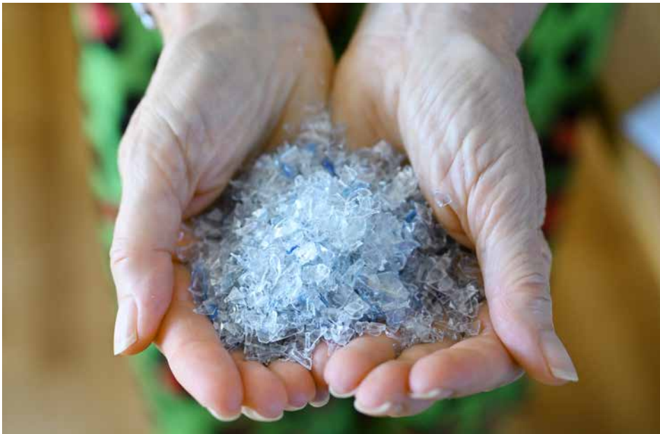
Für die Herstellung der Boxen wird sortenreines Getränke-PET-Granulat benötigt. Sonst dürften sie nachher nicht für Lebensmittel verwendet werden.
