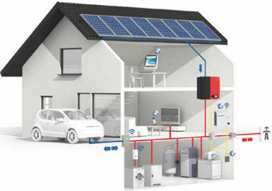
Mit einem Energiemanagementsystem (EMS) lässt sich der Solarstrom-Eigenverbrauch nochmals deutlich optimieren. [Energie Schweiz]
