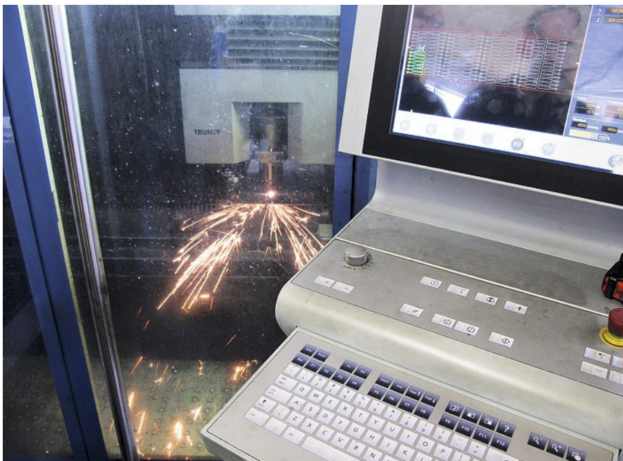
Auf dem Bildschirm wird der Fortschritt der Arbeit des Laserkopfs an der Platte angezeigt, über die Tastatur kann der wachsame Operateur eingreifen, dem Unregelmässigkeiten hinter dem Schutzglas nicht entgehen.
